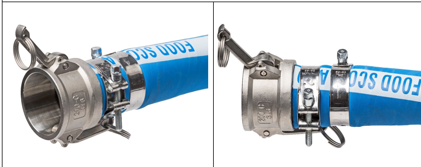
Spojka CAMLOCK typ C 2" z nerezí AISI 316 upevněná do hadice SCOTLAND NR DN51 pomocí dvou objímek SUPRA HEAVY DUTY W2
