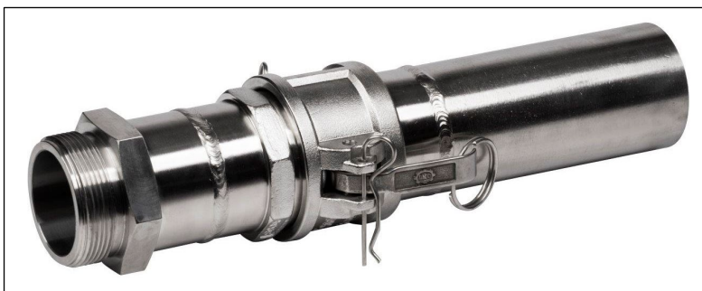
Spojka CAMLOCK navařená na tupo k bezešvé trubce EN10216-2 (index trubky: MPR-RBSZ-060X2,9-SS321) z nerez AISI 321.
