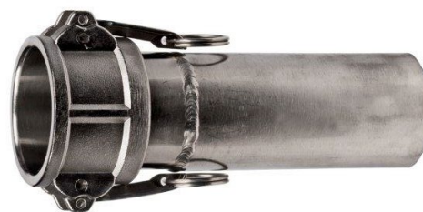
Spojka CAMLOCK navařená na tupo k bezešvé trubce EN10216-2 (index trubky: MPR-RBSZ-060X2,9-SS321) z nerez AISI 321.
