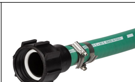
Hadice VACUPRESS CHEMI DN25 se spojkou IBC pro paletový kontejner (AC-IBF060-H100) z polypropylenu upevněnou pomocí dvou šnekových spon z nerezí AISI 316. Viditelné standardní bílé těsnění z polyetylenem LDPE.
