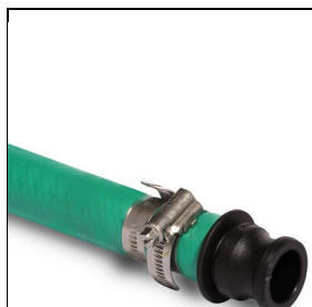
Hadice VACUPRESS CHEMI DN19 se vsuvkou spojky CAMLOCK z polypropylenu upevněnou pomocí dvou šnekových spon z nerezí AISI 316.
