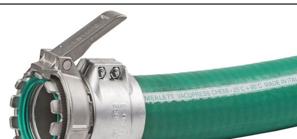
Hadice VACUPRESS CHEMI DN76 se spojkou TANK WAGEN (TW-MK-080-SS) z nerezí AISI 316 našroubovanou na koncovku s vnějším závitem (GD-VSLB-080-075-SS) z nerezí AISI 316 upevněnou na hadici pomocí hliníkové skořepinové montážní objímky. Viditelné standardní zelené těsnění z hypalonu (CSM).
