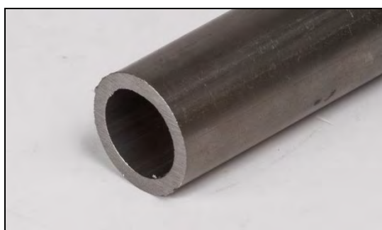
konec trubky po řezání pilou, viditelné ostré hrany a otřepy
