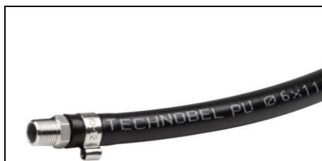
Hadice TECHNOBEL PU DN6 s namontovanou nerezovou koncovkou (AISI 316) s vnějším závitem BSPT 1/8" (NM-VT123-02). Montáž sponou EAR CLIP z nerez AISI 304 (AB-23012028).
